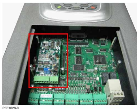
Figura 116: Placa encoder fixada no slot
