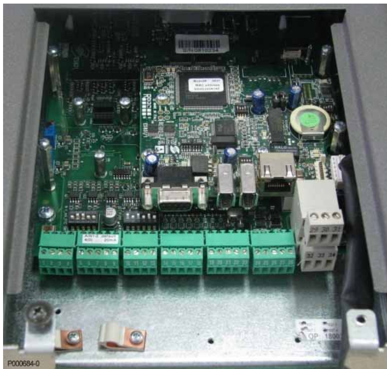
Figura 152: Placa DataLogger fixada no slot B
