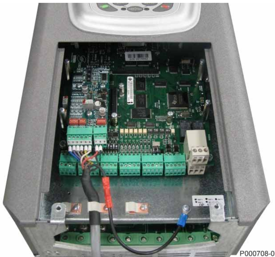
Figura 113: Ligação do cabo encoder
