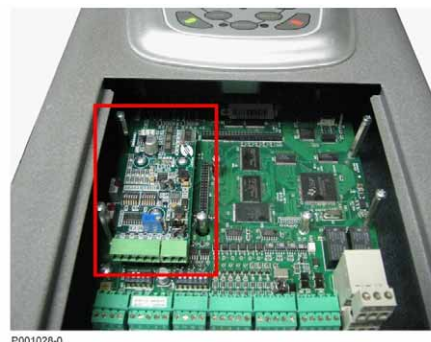
Figura 107: Placa encoder fixada no slot
