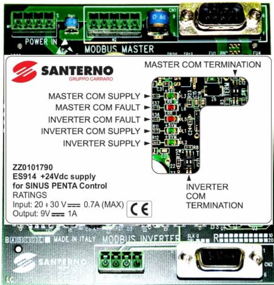
Figura 173: Posição de LED e DIP Switch
